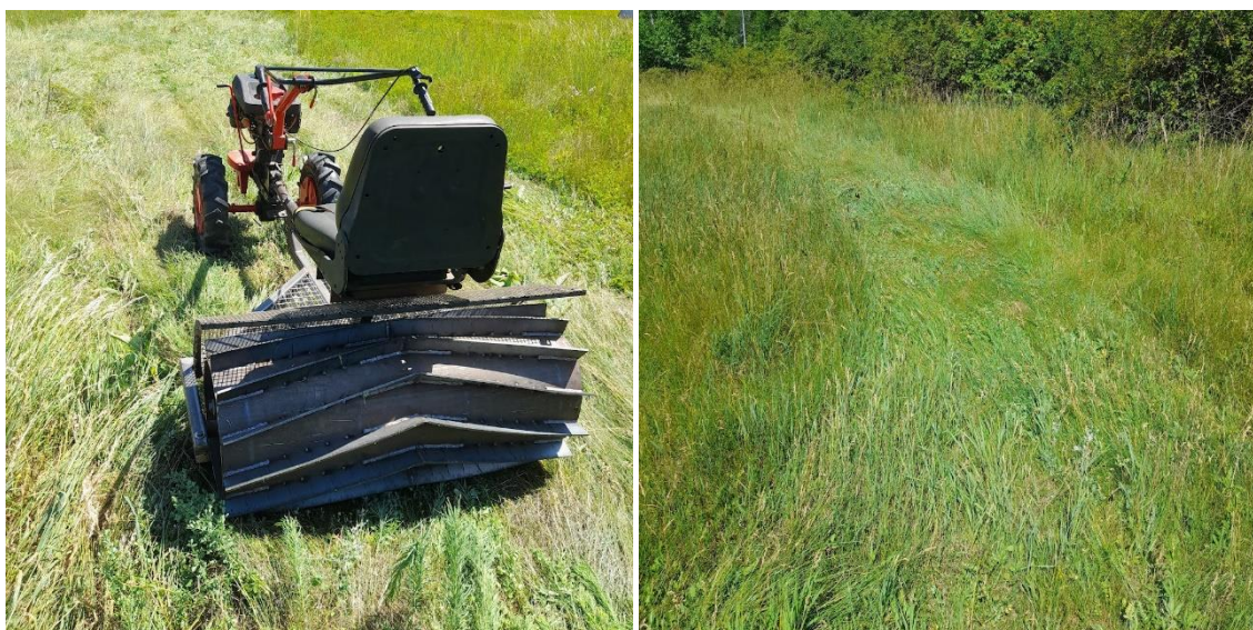
Obrázek 2 Nožový válec a porost vysokostébelných trav po použití této techniky (zdroj: MENDELU)
