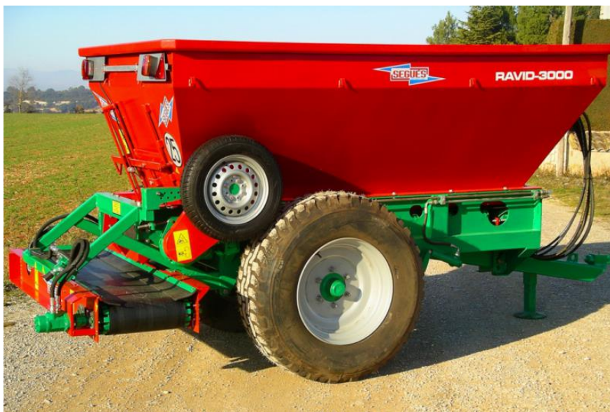
Obrázek 16 Rozmetadlo pro stranovou aplikaci pásovým dopravníkem (zdroj: web výrobce)
